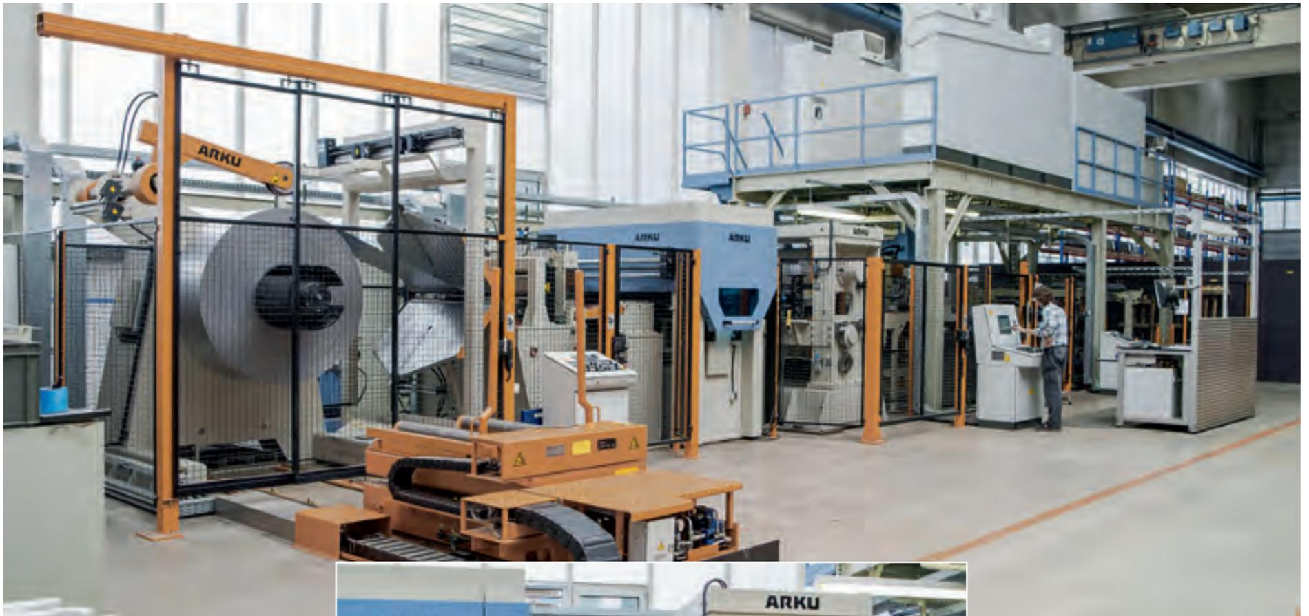
Querteilanlage zur Herstellung von Platinen für Haushaltsgeräte: Coilladewagen, Einseitenhaspel, Einführhilfe, Schopfschere, Hochleistungsrichtmaschine HiCap® 25 Plus, rotierende Querteilschere, Luftkissen-Stapelanlage.
